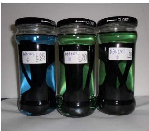
รูปที่ 3.21 การแช่ชิ้นงานทดสอบในรูปแบบดัมเบลล์ในน้ำมันแก๊สโซฮอล์
