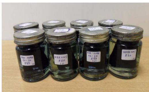
รูปที่ 3.20 การทดสอบการบวมตัวของชิ้นงานยางผสมในน้ำมันแก๊สโซฮอล์
