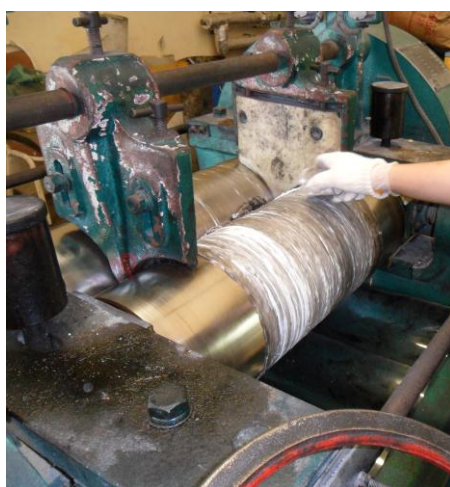
รูปที่ 3.9 การบดผสมยางกับสารเคมี
