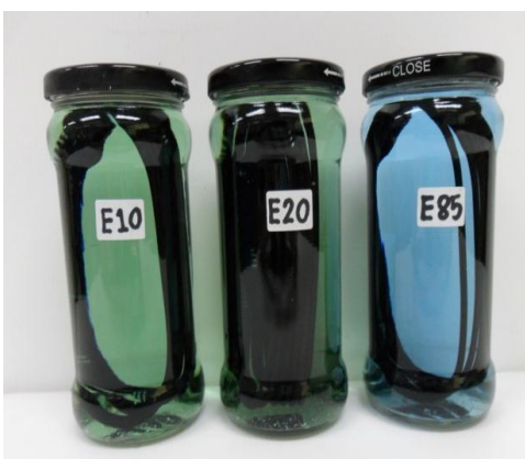
รูปที่ 3.22 การแช่ชิ้นงานทดสอบในรูปแบบโอริงในน้ำมันแก๊สโซฮอล์
