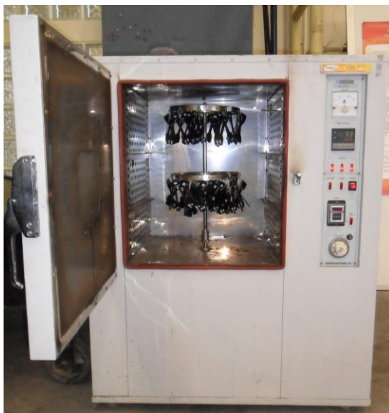
รูปที่ 3.23 การบ่มเร่งสภาวะขึ้นงานยางคงรูปด้วยความร้อนในตู้อบ
