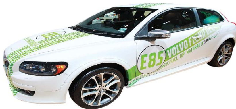
รูปที่ 2.1 รถยนต์ที่สามารถใช้เชื้อเพลิงได้อย่างหลากหลาย [10]
