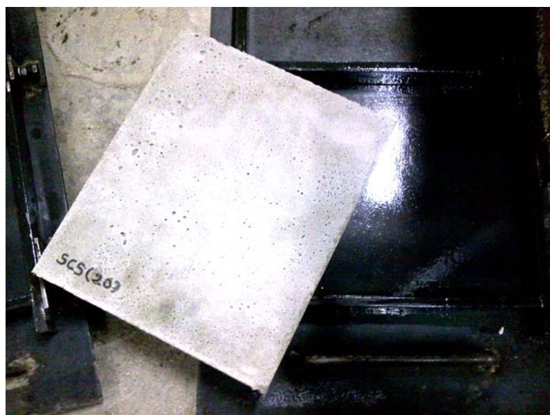
ภาพที่ จ. 12 ตัวอย่างสำหรับทดสอบค่าการส่งผ่านความร้อน
