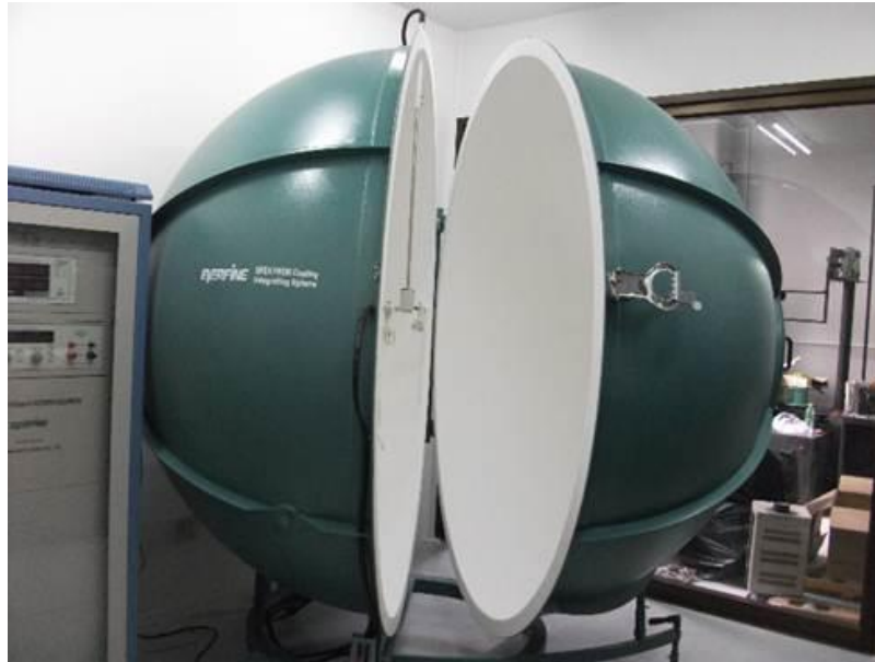
รูปที่ 5.1 แสดงอุปกรณ์การเรียนการสอนห้องปฏิบัติการระบบส่งสว่าง ใช้ในการทดสอบความสว่างของหลอดไฟ
