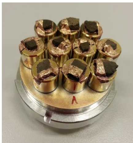
รูปที่ 3.1 ตัวอย่างจีโอพอลิเมอร์ที่ศึกษาโครงสร้างจุลภาค
