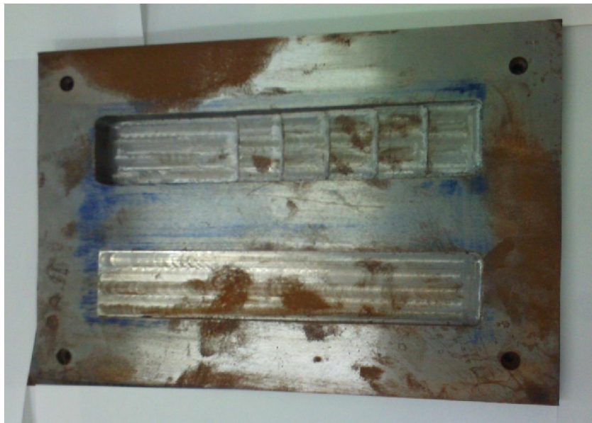
รูปที่ 3.19 ชิ้นงานทดสอบตัวอย่างที่กัดผิวลงไปที่มีความลึกต่างกัน
