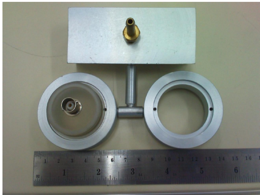
รูปที่ 3.15 ระบบจับยึดที่ออกแบบใหม่สำหรับการทดสอบแบบสองหัวทดสอบ
