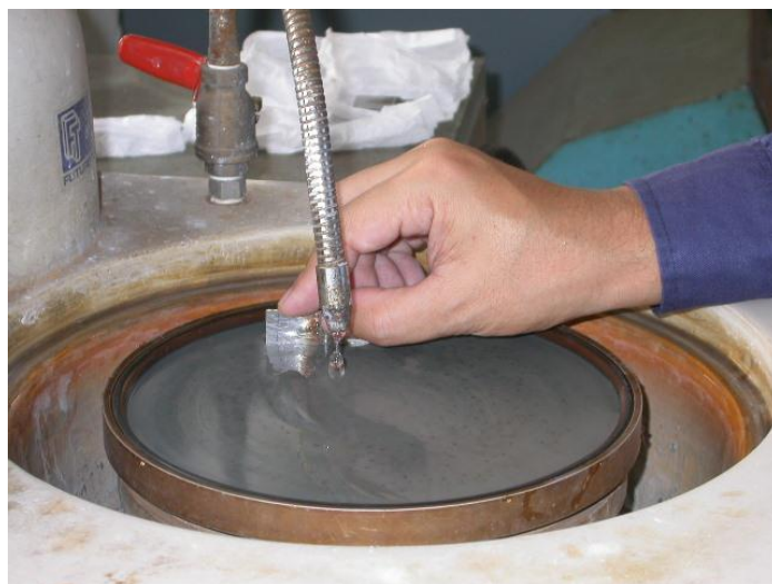
รูปที่ 3.11 การขัดผิวชิ้นงานด้วยกระดาษทราย
