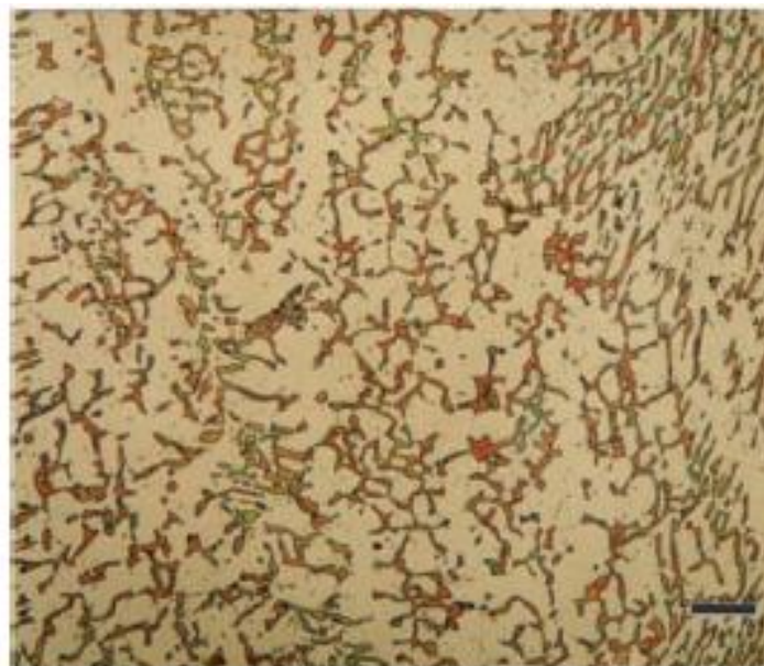
รูปที่ 2.6 การก่อตัวของเฟสซิกมา (สีเขียวและส้ม) จากเคลต้าเฟอร์ไรต์ในรอยเชื่อมเหล็กกล้าไร้สนิมชนิด 312 ที่ผ่านการบ่มที่อุณหภูมิ 816°C เป็นเวลา 160 ชั่วโมง โดยใช้สารละลาย Modified Murakami's reagent [6]
