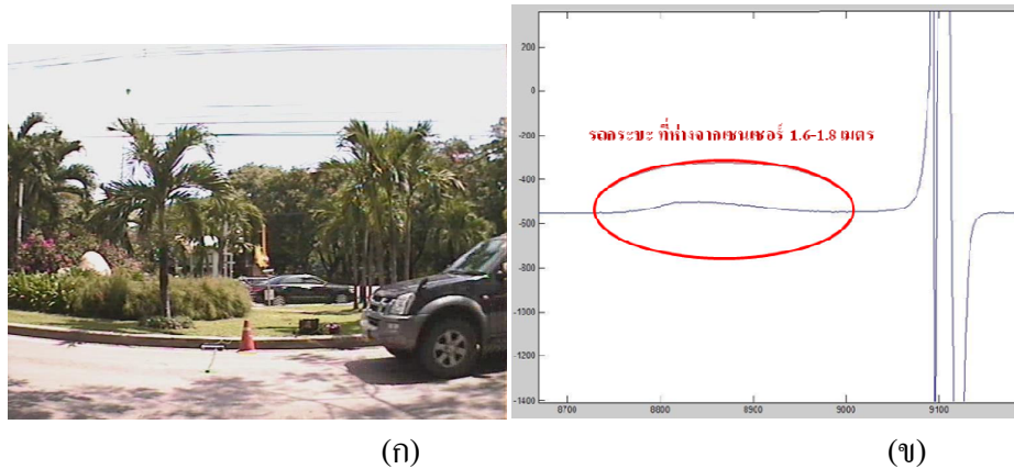
รูปที่ 4.8 ตัวอย่างเหตุการณ์ที่รถกระชากเคลื่อนที่มาแล้วหยุดก่อนถึงเซนเซอร์
