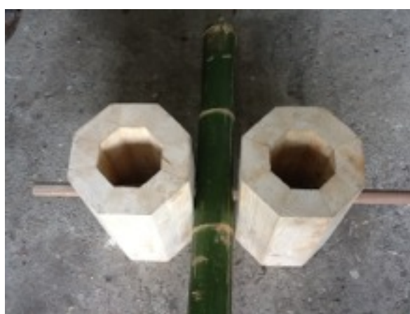
ภาพที่ 72 ก้านเหยียบของกระตึงดนตรีด้วยลำไม้ไผ่ หลักไม้สองข้างทำหน้าที่ยึด โดยมีแกนไม้ทำหน้าที่เป็นจุดหมุนของก้านเหยียบ
