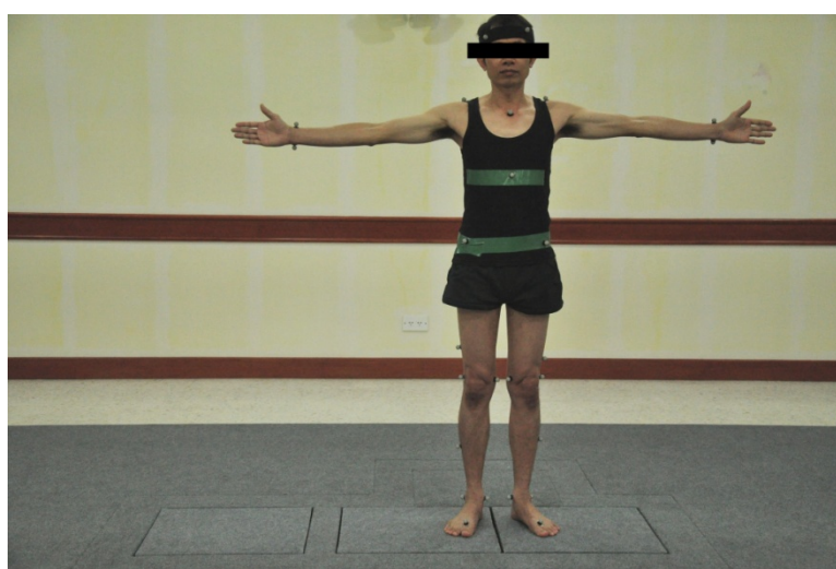
รูปที่ 3.12 แสดงการทำ Static capture โดยการยืนอยู่บน Force plate ด้วยการพยายามทิ้งน้ำหนักตัวทั้งหมดลงบนเท้าทั้ง 2 ข้างเท่าๆกัน
