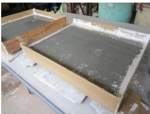
ภาพที่ 4.15 การทดสอบการไม่รั่วซึมน้ำ ในช่วงเริ่มการทดสอบ
