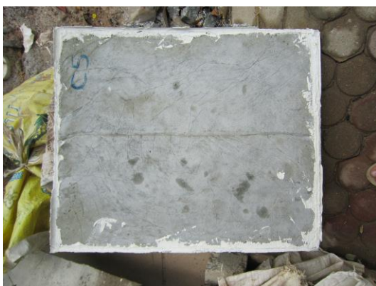
ภาพที่ 4.16 แผ่นกระเบื้องตัวอย่างที่ผ่านการทดสอบการซึมน้ำ
