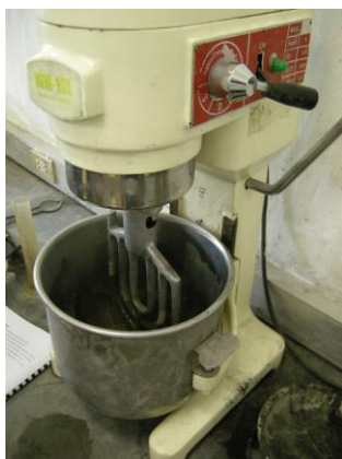
ภาพที่ 3.9 เครื่องผสมส่วนผสมซีเมนต์ ยี่ห้อ World Materies รุ่น WM-10L และแบบพิมพ์
