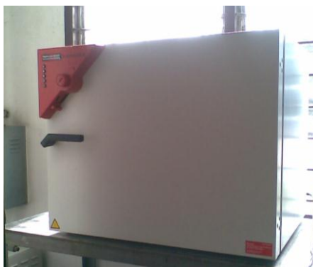
ภาพที่ 3.8 ตู้อบ สามารถปรับอุณหภูมิได้ ยี่ห้อ Binder
