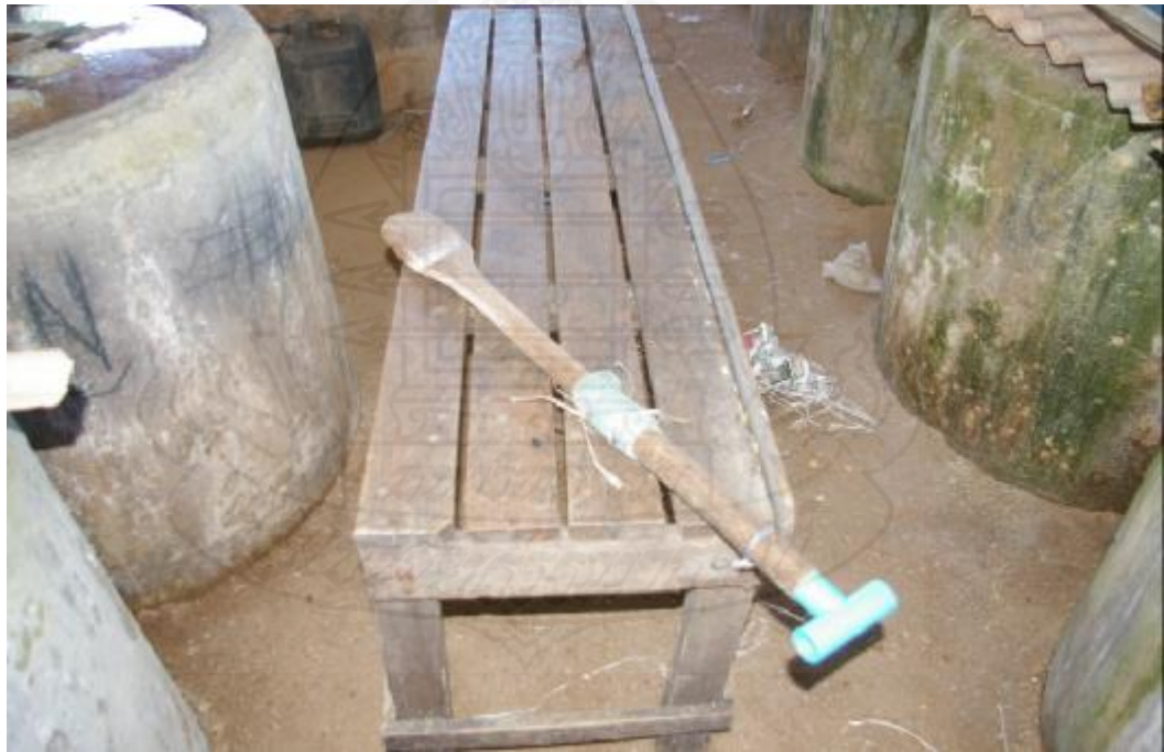
ภาพที่ 4.33 รูปไม้พาย ที่คุณถ้วนชาริสะห์ ได้ดัดแปลงส่วนที่ด้ามจับหัก โดยสวมทับด้วยท่อน้ำพีวีซี และสามารถนำไปใช้งานต่อได้โดยไม่ต้องซื้อหามาเปลี่ยนใหม่
