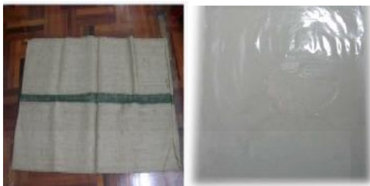
ภาพที่ 4.27 รูป กระสอบป่านและ ถุงพลาสติกใส ที่ใช้ในการปิดปากบ่อหมัก
