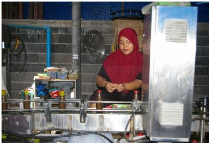
ภาพที่ 4.17 ภาพคนงานกำลังปิดฝาและติดสติ๊กเกอร์เครื่องหมายการค้า โดยใช้เครื่องจักร ถ่ายทำ ณ. โรงผลิตน้ำบูดู ของ คุณอับรอเฮม แม
