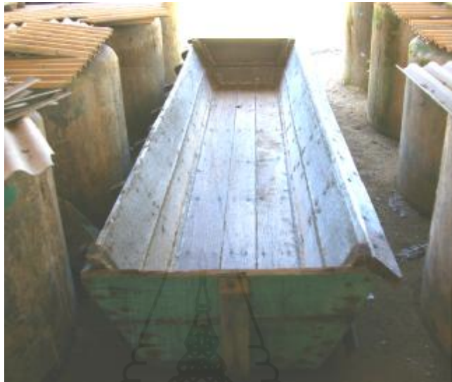
ภาพที่ 4.24 รูปกะเบาะสำหรับคลุกเคล้าส่วนผสมหรือ ปราฮู ในภาษามลายูท้องถิ่น ที่ล้างทำความสะอาดเรียบร้อยแล้ว รอการนำมาใช้งาน
