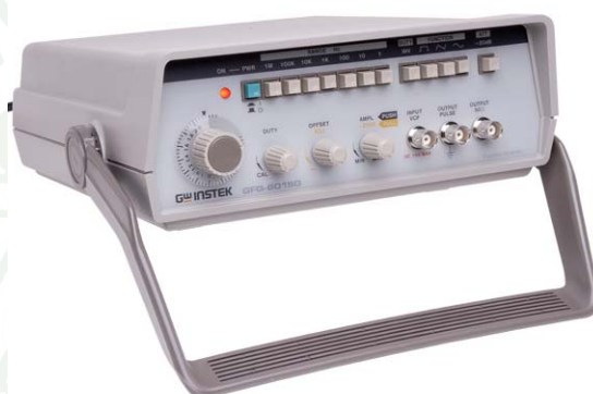
ภาพผนวกที่ ข23 เครื่องกำเนิดสัญญาณคลื่นความถี่ รุ่น GFG-8015G ผลิตโดยบริษัท GW Instek
