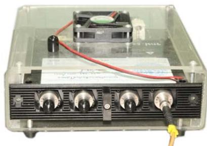
ภาพผนวกที่ ข22 เครื่องตรวจวัดโฟตอนเดี่ยว รุ่น SPCM-AQ4C ผลิตโดยบริษัท PerkinElmer
