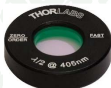
ภาพผนวกที่ ข7 แผ่นครึ่งคลื่นอันดับที่ศูนย์ ความยาวคลื่น 405 นาโนเมตร ผลิตโดยบริษัท Thorlabs
