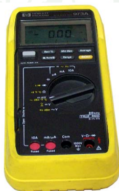
ภาพผนวกที่ ข20 มัลติมิเตอร์ รุ่น HP973A ผลิตโดยบริษัท Hewlett Packard
