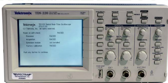
ภาพผนวกที่ ข24 ออสซิลโลสโคป รุ่น TDS220 ผลิตโดยบริษัท Tektronix
