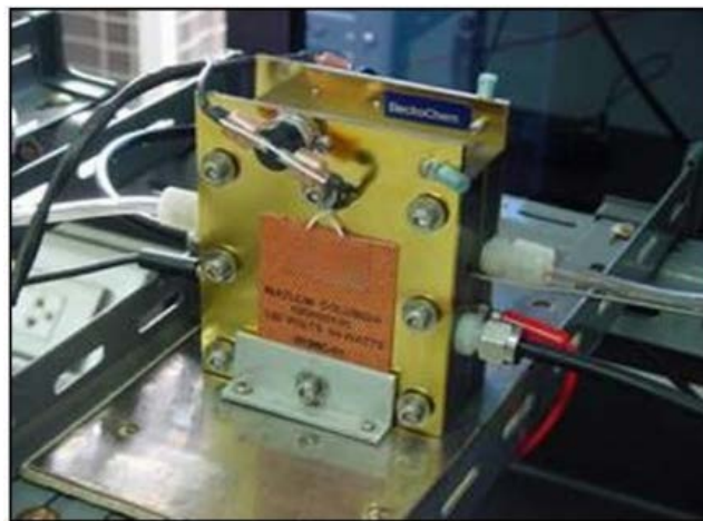
รูปที่ 2.7 เซลล์เชื้อเพลิงแบบเมมเบรนแลกเปลี่ยนโปรตอนสำหรับงานวิจัยพื้นที่ขนาด 5 cm 2 [4]
