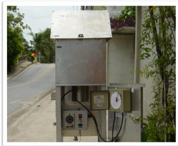
รูปที่ 3.3 เครื่องเก็บตัวอย่าง TSP High Volume Air Sampler [23]
