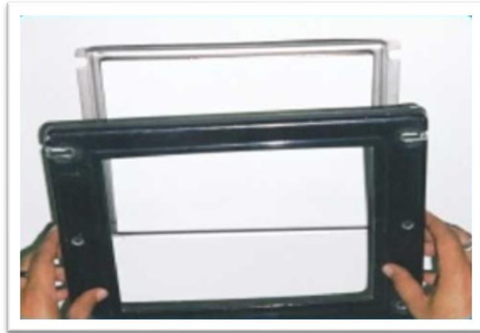
รูปที่ 3.4 การวางกระดาษกรองสำหรับเก็บตัวอย่าง TSP และ PM 10 [4]
