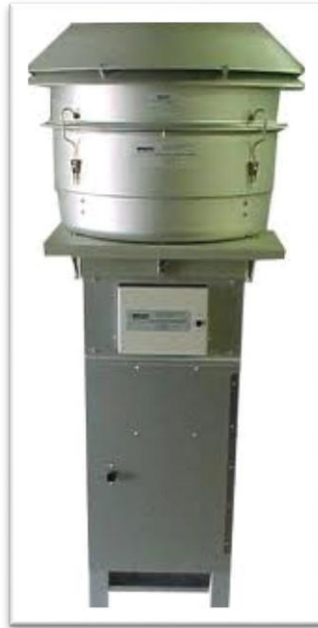
รูปที่ 3.2 เครื่องเก็บตัวอย่าง PM 10 High Volume Air Sampler [23]
