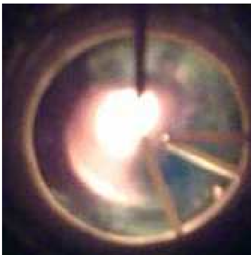
รูปที่ ค.1 แสดงเปลวไฟการเผาไหม้แบบ free flame กรณี X_{PB} = -20 มิลลิเมตร
