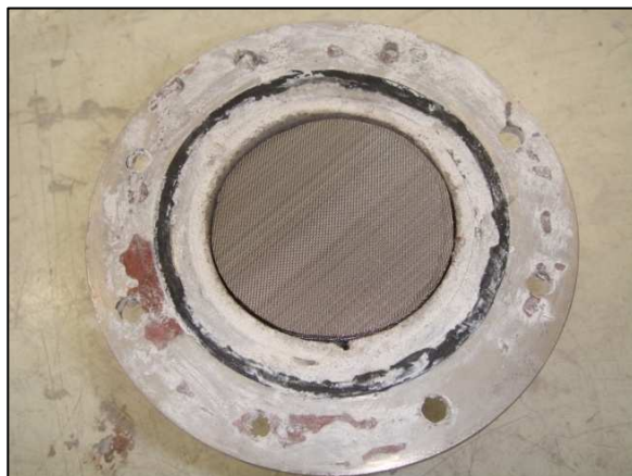
รูปที่ ก.3 ตาข่ายสแตนเลสขนาด 40 mesh/inch (PB)
