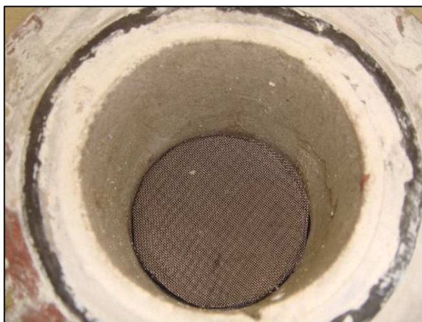
รูปที่ ก.3 ตาข่ายสแตนเลสขนาด 40 mesh/inch (PB)
