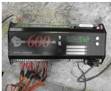
รูปที่ ก.9 อุปกรณ์เก็บบันทึกค่าอุณหภูมิ (Data Logger รุ่น DT600) และคอมพิวเตอร์บันทึกข้อมูล
