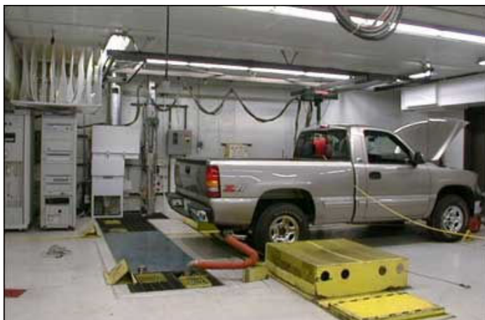
รูปที่ 2.5 การทดสอบอัตราการสิ้นเปลืองเชื้อเพลิงในห้องทดสอบตามมาตรฐานของ US Café [11]
