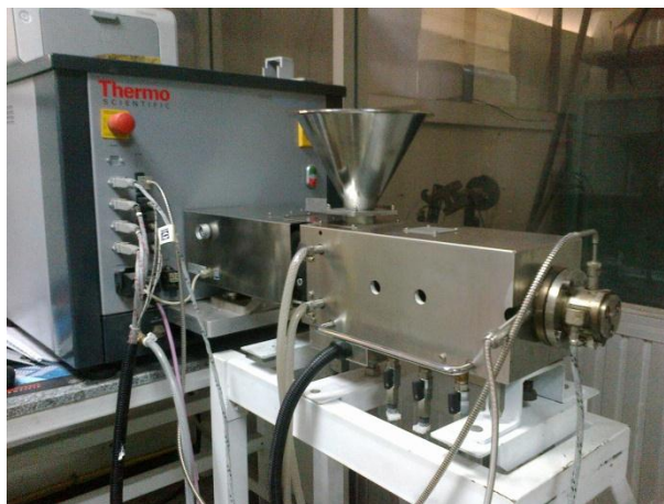
รูปที่ 3.6 เครื่องอัดรีดแบบเกลียวหนอนคู่
