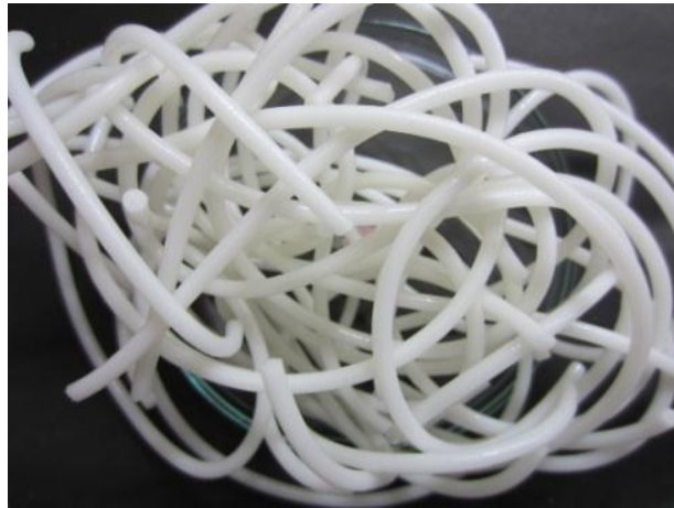
รูปที่ ค.2 ลักษณะของพีวีซีคอมปาวด์ที่ออกจากหัวดายเมื่อใช้ EMPO : ESO ในสัดส่วน 20 : 40 pph
