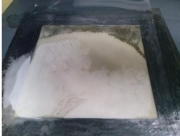
รูปที่ 4.19 ลักษณะของพีวีซีคอมปาวด์ที่ใช้ MPO เมื่อขึ้นรูปเป็นแผ่นซีท
