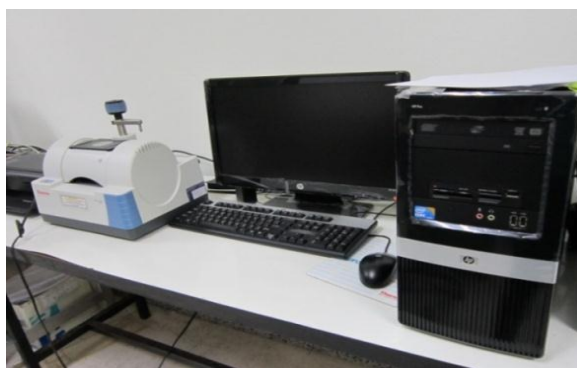
รูปที่ 3.4 เครื่องฟูเรียร์ทรานส์ฟอร์มอินฟราเรดสเปกโตรสโคปี (ATR - FTIR)
