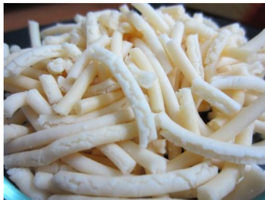
รูปที่ 4.18 ลักษณะของพีวีซีคอมปาวด์เมื่อใช้ MPO ในสัดส่วน 20 pph
