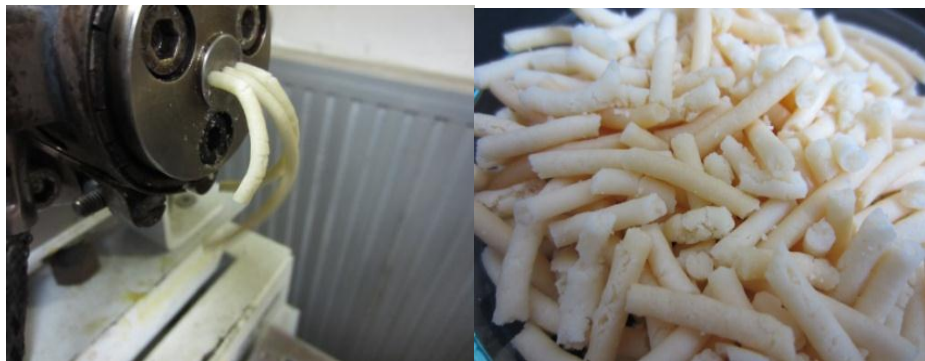
รูปที่ 4.17 ลักษณะของพีวีซีคอมปาวด์เมื่อใช้ MPO ในสัดส่วน 60 pph
