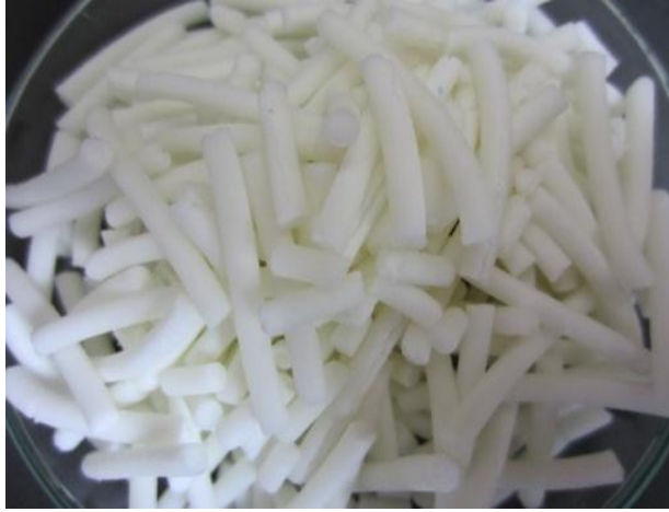
รูปที่ ค.1 ลักษณะของพีวีซีคอมปาวด์ที่ออกจากหัวดายเมื่อใช้ EMPO : ESO ในสัดส่วน 30 : 30 pph
