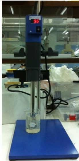
รูปที่ 2.4 ลักษณะของเครื่องผสมที่ใช้ในการทำให้เป็นเนื้อเดียวกันด้วยความเร็วสูง
