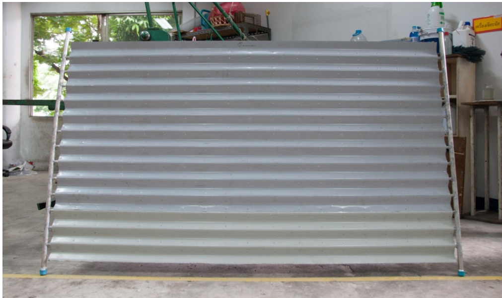
รูปที่ 3.7 แผ่นดัดกลิ้งรังสีอาทิตย์รุ่นต่างๆ ที่ผ่านการประกอบกับท่ออะลูมิเนียมโดยใช้แผ่นยึดติดเป็นตัวยึดติด ด้านหน้า a.) CL-825 และ b.) CL-750D
