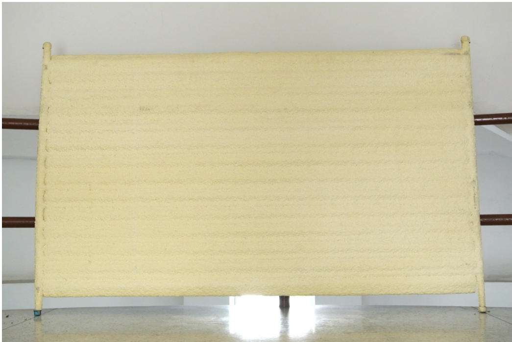
รูปที่ 3.12 แผ่นคูดกลืนรังสีอาทิตย์ที่ผ่านการพ่นฉนวนพอลิยูรีเทนที่มีความหนา 25 mm
