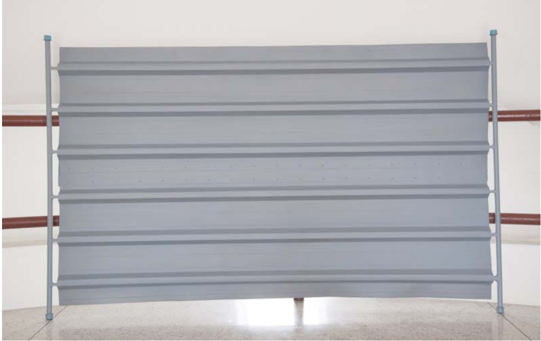
รูปที่ 3.9 แผ่นดัดกลืนรังสีอาทิตย์ที่ผ่านการฟันสีด้วยสีร่องฟัน
