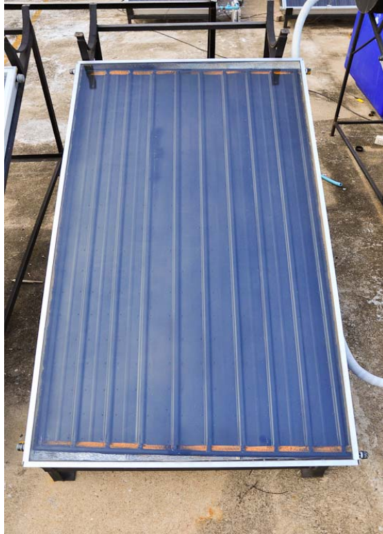
รูปที่ 3.15 ตัวเก็บรังสีอาทิตย์แบบแผ่นโลหะ รุ่น CL-825 แบบมีกระจกปิด
