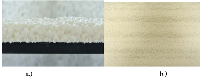
รูปที่ 3.13 a.) ความหนาของฉนวนพอลิยูรีเทนขนาดความหนาประมาณ 2.5 mm b.) ลักษณะของฉนวนพอลิยูรีเทน
