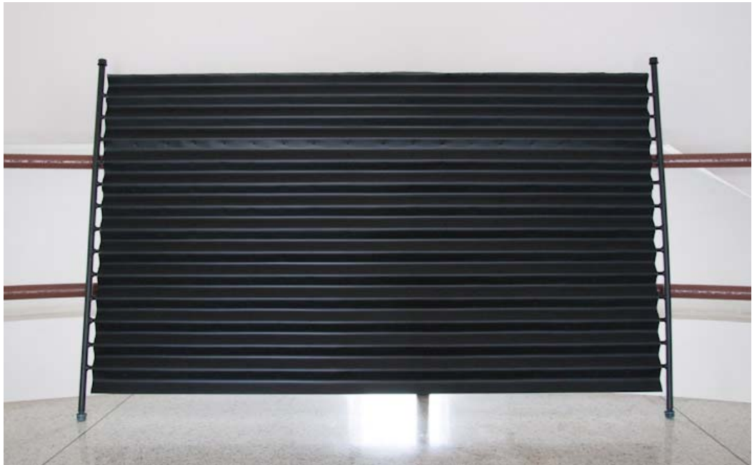
รูปที่ 3.10 แผ่นดัดกลืนรังสีอาทิตย์ที่ผ่านการฟันสีด้วยสีดำด้านทับสีร่องฟัน
