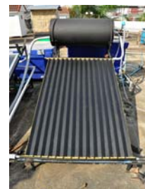
รูปที่ 4 ตัวเก็บรังสีอาทิตย์แบบแผ่นโลหะที่พร้อมทดสอบ
