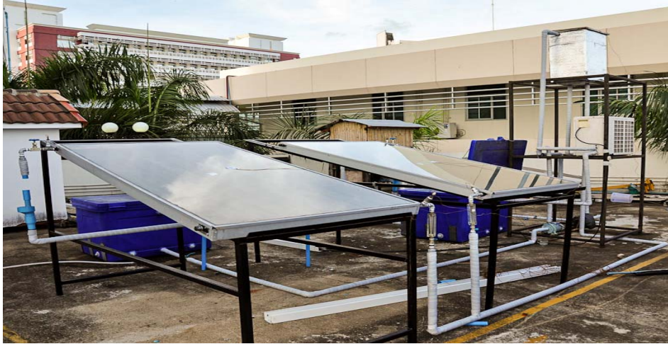
รูปที่ 3.29 รูปการทดสอบหาประสิทธิภาพของตัวเก็บรังสีอาทิตย์ ตามมาตรฐาน ISO 9806-1
