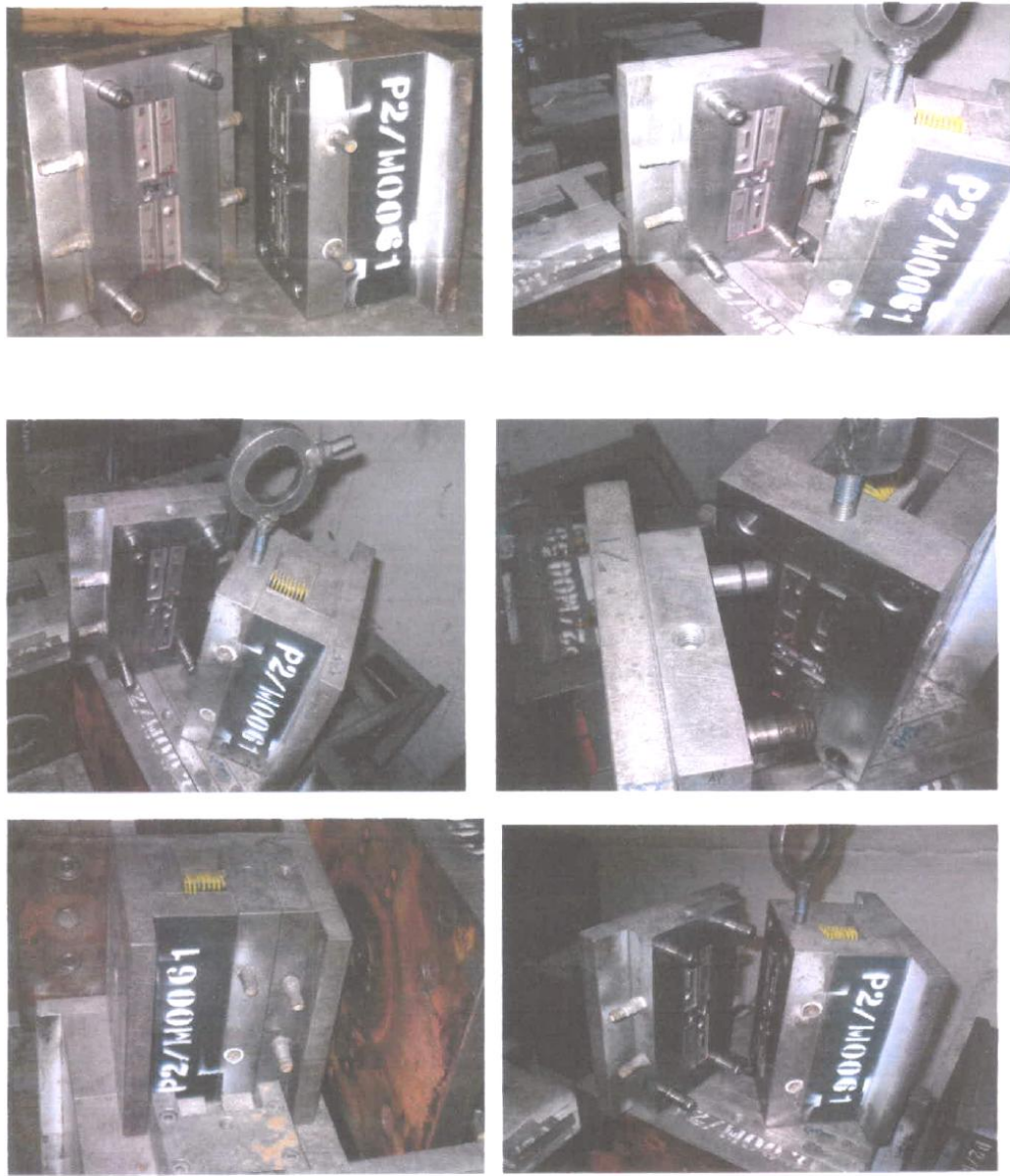
ภาพที่ 17 แม่พิมพ์ (Mold) สำหรับผลิตกล่องชุดตรวจวินิจฉัยโรคเท้าช้างแบบรวดเร็ว FilariaDIAG RAPID
