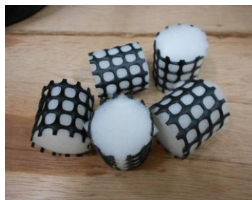
รูปที่ 3.1 ตัวกลางฟองน้ำที่ใช้ในระบบ DHS
