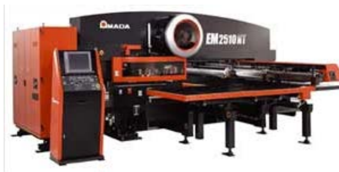
รูปที่ 2.4 วิธีการตัดแบบเจาะระบบหัวตอก (Punching)
