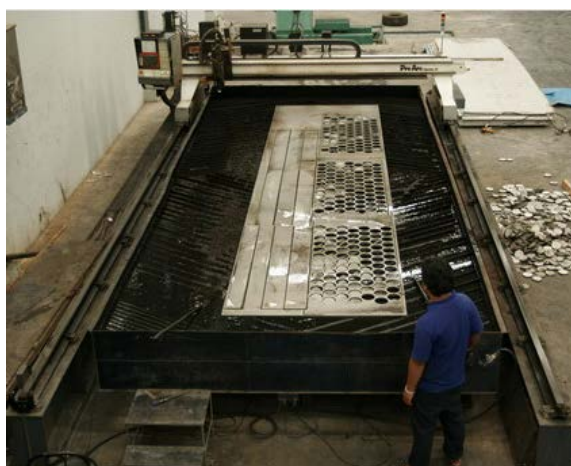
รูปที่ 2.1 วิธีการตัดแบบพลาสมา
