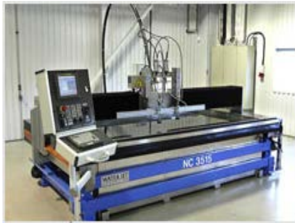
รูปที่ 2.3 วิธีการตัดแบบแรงดันน้ำ (Water Jet)
