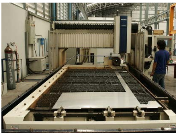
รูปที่ 2.2 วิธีการตัดแบบเลเซอร์
