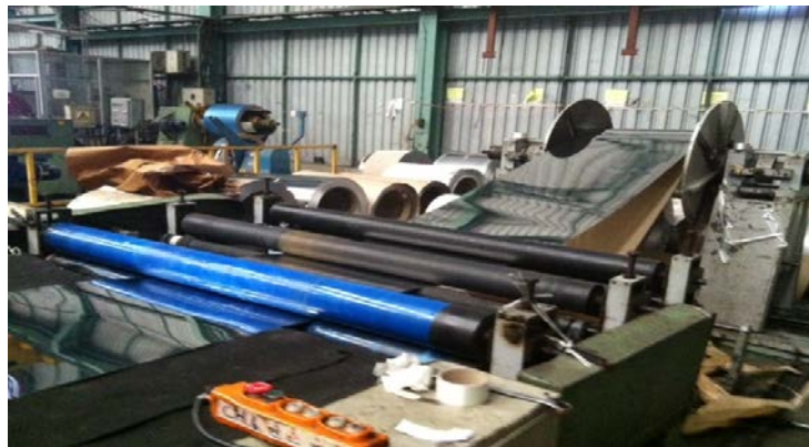
รูปที่ 3.3 กระบวนการตัดแผ่นโดยใช้มิดกีโยดลิน
