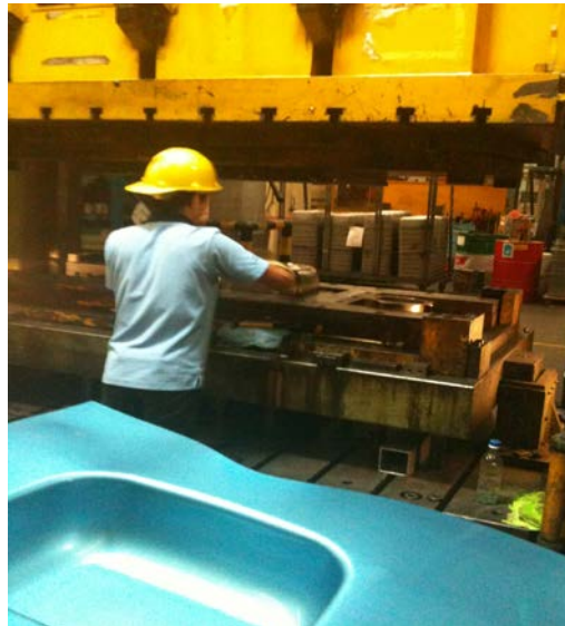
รูปที่ 3.5 กระบวนการปั๊มขึ้นรูปภาชนะล้างจานสแตนเลส
