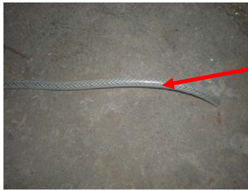
รูปที่ 3.5 ลักษณะของท่อที่ใช้ส่งแก๊สไฮโดรเจนและออกซิเจน
