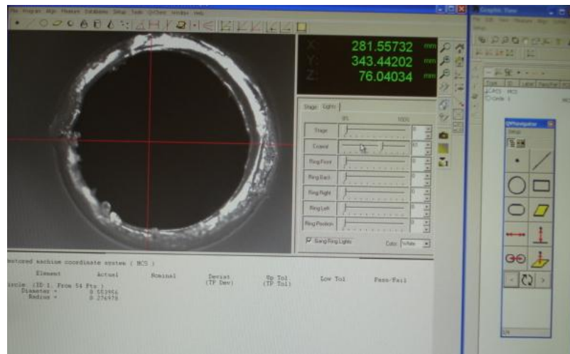
รูปที่ 4.2 ผลการวัดเส้นผ่านศูนย์กลางของ Drip-tube โดยใช้เครื่อง CNC Vision Measuring Machine
