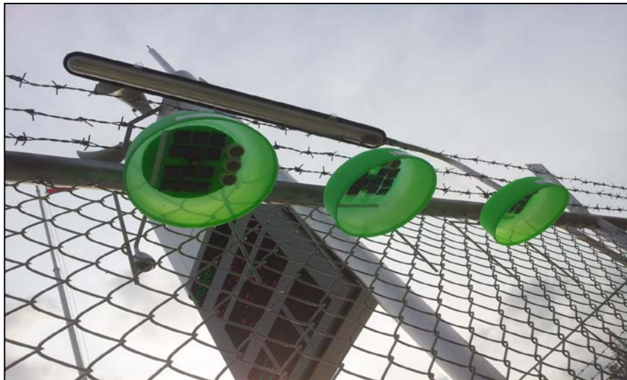
รูปที่ 3.2 การติดตั้งอุปกรณ์เก็บอากาศแบบพาสซีฟ ตามสถานีตรวจวัดคุณภาพอากาศของกรมควบคุมมลพิษ กระทรวงทรัพยากรธรรมชาติและสิ่งแวดล้อม
