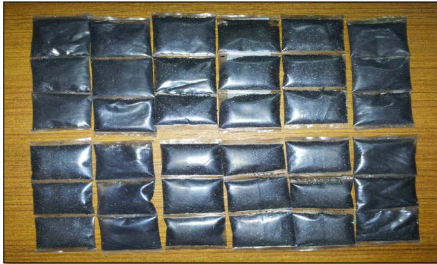
รูปที่ 3.1 อุปกรณ์เก็บอากาศแบบพาสซีฟ LDPE ขนาด 2.5 x 2.5 เซนติเมตร จำนวนชุดละ 3 ชุด
