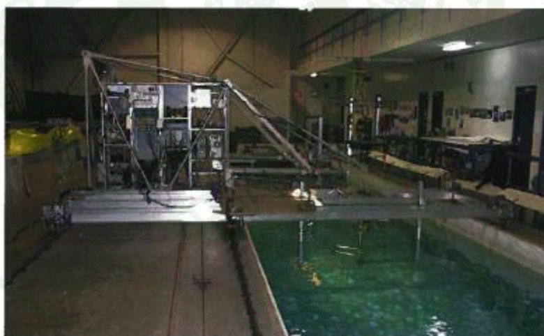
ภาพที่ 11 การทดลอง Vertical Axis Turbine ใน Towing Tank
