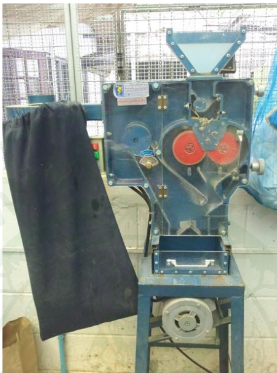
ภาพที่ 8 เครื่องกะเทาะเปลือก (รุ่น P-1 จัดจำหน่ายโดยห้างหุ้นส่วนจำกัด เน็กเซนด์ฮวด)
