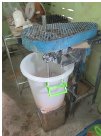
ภาพที่ 4.15 เครื่องผสมแป้งที่ดัดแปลงเอง
