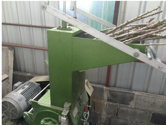
รูปที่ 2 การบดย่อยต้นมันสำปะหลังทิ้งให้มีขนาดผ่านตะแกรงเบอร์ 4
