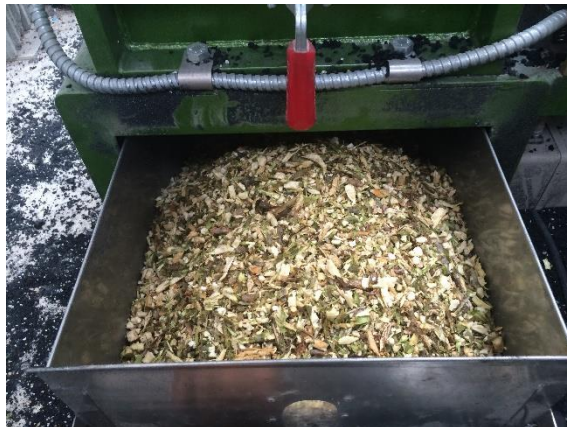
รูปที่ 3 เศษต้นมันสำปะหลังที่ผ่านการย่อยให้มีขนาดผ่านตะแกรงเบอร์ 4
