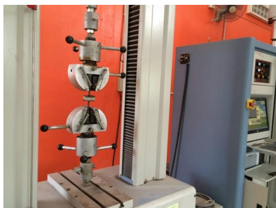
รูปที่ 3.36 การติดตั้งแผ่นผนังไม้เทียมจากต้นมันสำปะหลังผสมซีเมนต์สำหรับทดสอบความต้านทานแรงดัดตั้งฉากกับผิวหน้า
