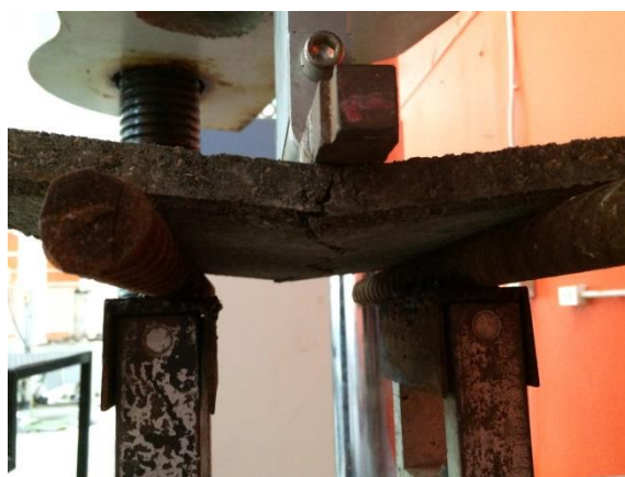
รูปที่ 3.35 ลักษณะการวิบัติของแผ่นผนังไม้เทียมจากต้นมันสำปะหลังผสมซีเมนต์จากการทดสอบความต้านทานแรงดัดและมอดุลัสยืดหยุ่น
