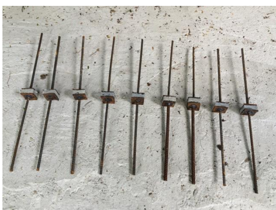
รูปที่ 3.14 ตัวอย่างแผ่นผนังไม้เทียมจากต้นมันสำปะหลังผสมซีเมนต์อัตราส่วนต่างๆ สำหรับทดสอบความต้านทานแรงดึงตั้งฉากกับผิวหน้า
