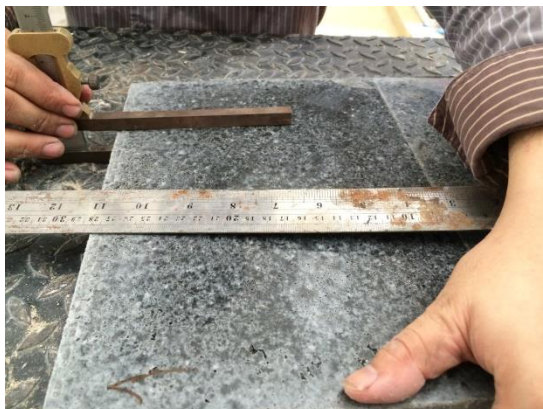
รูปที่ 3.28 การวัดขนาดและพิจารณาลักษณะทั่วไปของแผ่นผนังไม้เทียมจากต้นมันสำปะหลังผสมซีเมนต์
