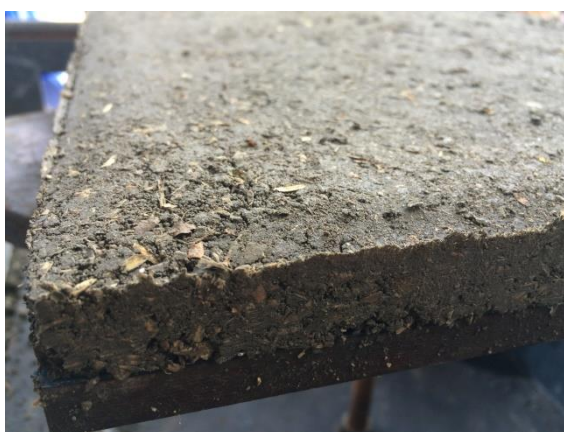
รูปที่ 4.1 ขอบของแผ่นผนังไม้เทียมจากต้นมันสำปะหลังผสมซีเมนต์ที่เริ่มมีการหลุดร่อน
