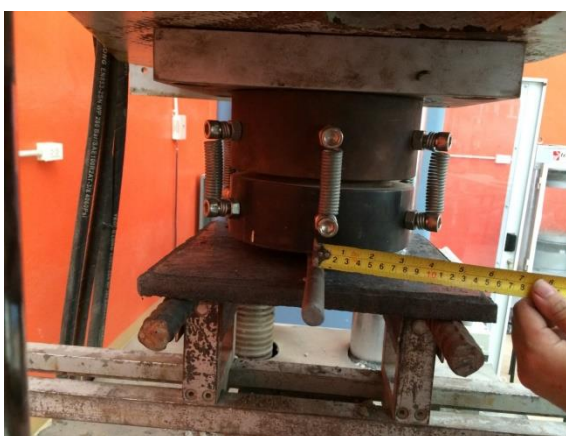
รูปที่ 3.32 การติดตั้งแผ่นผนังไม้เทียมจากต้นมันสำปะหลังผสมซีเมนต์ เพื่อทดสอบความต้านทานแรงดัดและมอดุลัสยืดหยุ่น
