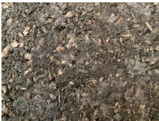
รูปที่ 3.27 เนื้อของแผ่นผนังไม้เทียมที่ได้จากการอัด
