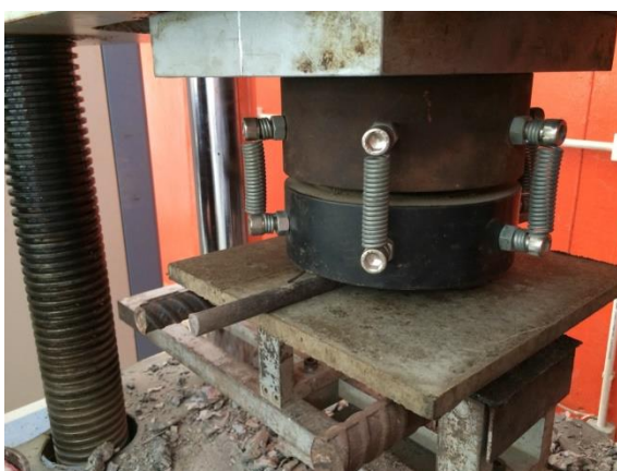
รูปที่ 3.33 การทดสอบความต้านทานแรงดัดและมอดุลัสยืดหยุ่นของ แผ่นผนังไม้เทียมจากต้นมันสำปะหลังผสมซีเมนต์
