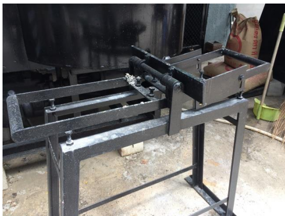
รูปที่ 3.7 แท่นพลิกแผ่นผนังไม้เทียม
