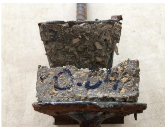
รูปที่ 3.38 ลักษณะการวิบัติของแผ่นผนังไม้เทียมจากต้นมันสำปะหลังผสมซีเมนต์ จากการทดสอบความต้านทานแรงดัดตั้งฉากกับผิวหน้า
