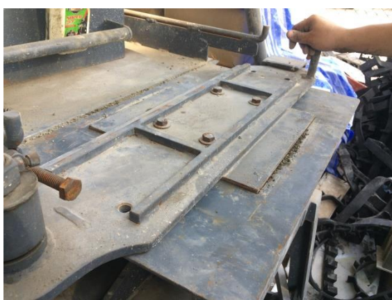
รูปที่ 3.22 การอัดขึ้นรูปและสันเขย่าส่วนผสมด้วยเครื่องอัดแผ่นผนังไม้เทียมให้แน่น
