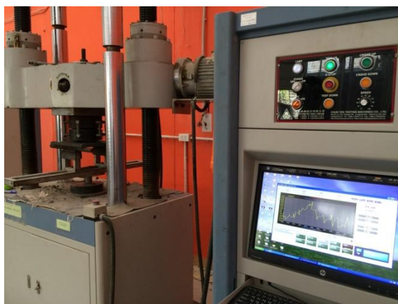
รูปที่ 3.34 การอ่านผลการทดสอบความต้านทานแรงดัดและมอดุลัสยืดหยุ่นของแผ่นผนังไม้เทียมจากต้นมันสำปะหลังผสมซีเมนต์ด้วยคอมพิวเตอร์
