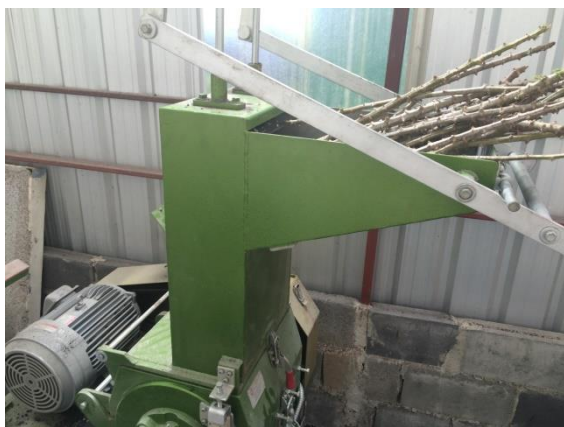
รูปที่ 3.8 เครื่องบดต้นมันสำปะหลัง พร้อมตะแกรงเบอร์ 4 หรือ 4.76 มิลลิเมตร
