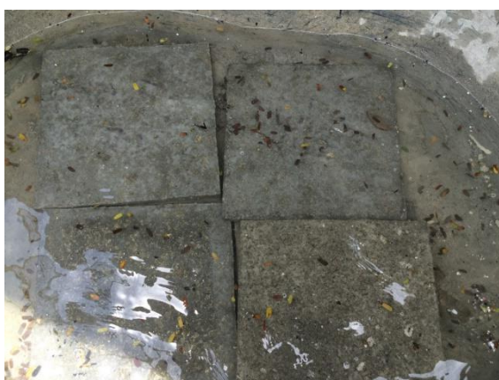
รูปที่ 3.30 การแช่น้ำแผ่นผนังไม้เทียมจากต้นมันสำปะหลังผสมซีเมนต์เพื่อทดสอบการพองตัว
