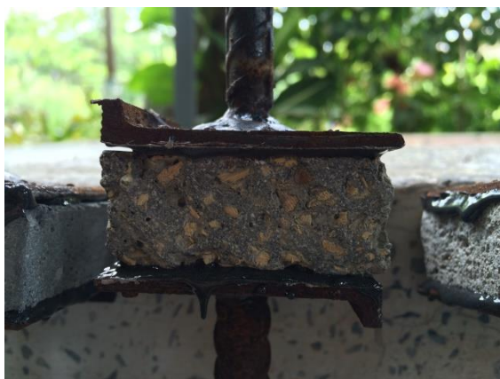
รูปที่ 3.13 การยึดแผ่นผนังไม้เทียมจากต้นมันสำปะหลังผสมซีเมนต์เข้ากับแท่งเหล็ก สำหรับทดสอบความต้านทานแรงดึงตั้งฉากกับผิวหน้า
