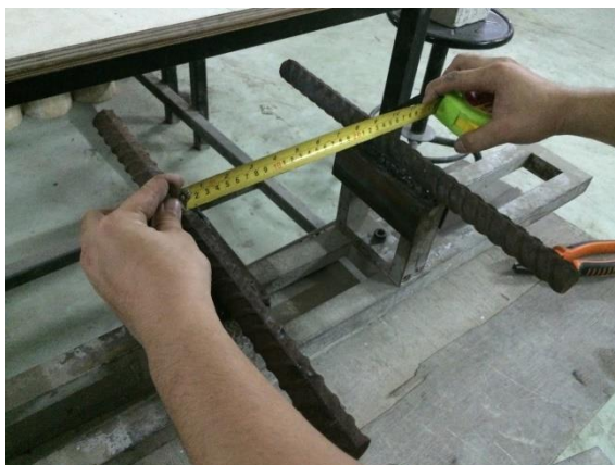
รูปที่ 3.31 การเตรียมแท่นสำหรับทดสอบความต้านทานแรงดัดและมอดุลัสยืดหยุ่น ของแผ่นผนังไม้เทียมจากต้นมันสำปะหลังผสมซีเมนต์
