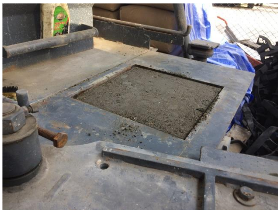
รูปที่ 3.23 ผลจากการอัดขึ้นรูปและสั่นเขย่าส่วนผสมของแผ่นผนังไม้เทียม
