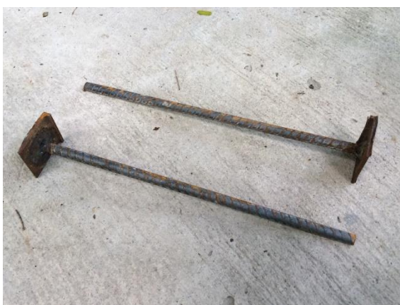
รูปที่ 3.10 แผ่นเหล็กและเหล็กข้ออ้อยที่ถูกเชื่อมเพื่อรองรับการทดสอบ ความต้านทานแรงดึงตั้งฉากกับผิวหน้า
