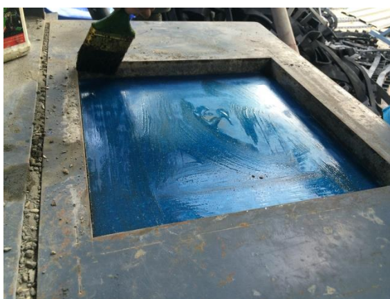
รูปที่ 3.20 การรองแผ่นพลาสติกและทาน้ำมันบนแบบหล่อของเครื่องอัดแผ่นผนังไม้เทียมแบบสั่นเขย่า
