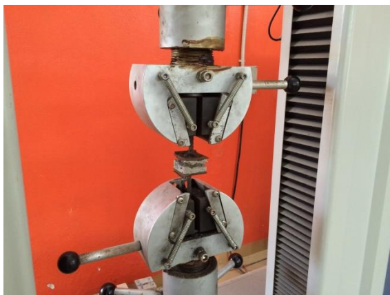
รูปที่ 3.37 การทดสอบความต้านทานแรงดัดตั้งฉากกับผิวหน้าของแผ่นผนังไม้เทียมจาก ต้นมันสำปะหลังผสมซีเมนต์ด้วยเครื่องทดสอบอเนกประสงค์
