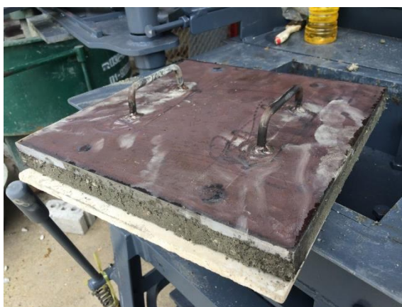
รูปที่ 3.24 การถอดแบบของแผ่นผนังไม้เทียม
