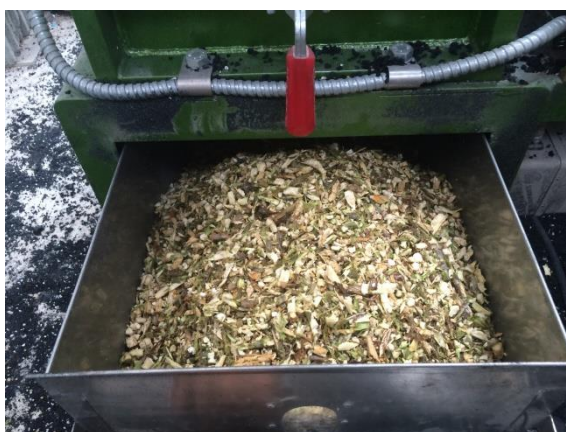
รูปที่ 3.18 เศษต้นมันสำปะหลังที่ผ่านการย่อยขนาดด้วยเครื่องบด
