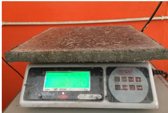
รูปที่ 5 การชั่งน้ำหนักแผ่นผนังไม้เทียมผสมต้นมันสำปะหลัง
