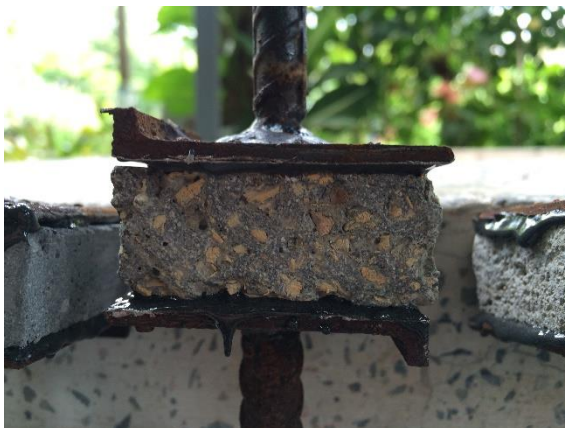
รูปที่ 7 เนื้อของแผ่นผนังไม้เทียมผสมต้นมันสำปะหลังก่อนทดสอบความต้านทานแรงดึงที่ผิวหน้า
