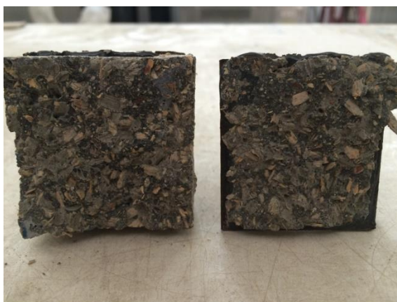
รูปที่ 3.39 ลักษณะเนื้อของแผ่นผนังไม้เทียมจากต้นมันสำปะหลังผสมซีเมนต์ จากการทดสอบความต้านทานแรงดัดตั้งฉากกับผิวหน้า
