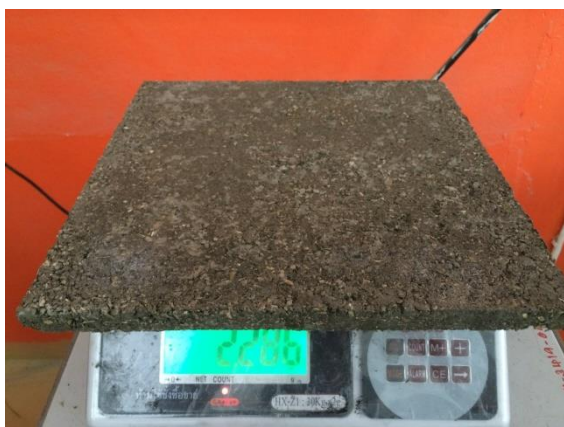
รูปที่ 3.29 การชั่งน้ำหนักแผ่นผนังไม้เทียมจากต้นมันสำปะหลังผสมซีเมนต์
