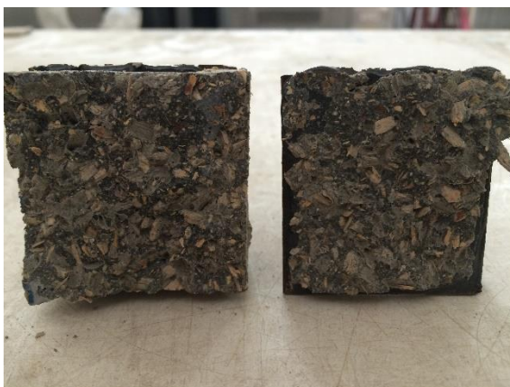
รูปที่ 8 ความเสียหายที่ผิวหน้าจากการทดสอบการรับแรงดึงของแผ่นผนังไม้เทียมผสมต้นมันสำปะหลัง
