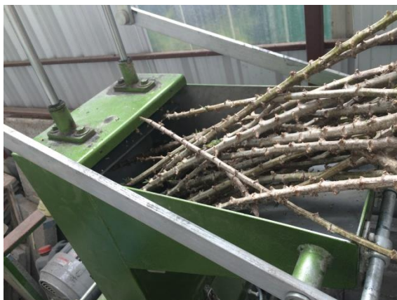
รูปที่ 3.17 การใส่ต้นมันสำปะหลังลงย่อยขนาดในเครื่องบด
