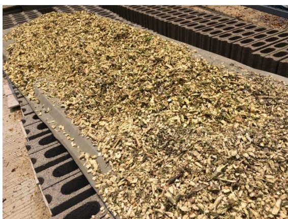
รูปที่ 3.19 การตากแดดเศษต้นมันสำปะหลังให้แห้งก่อนนำไปผสมเป็นแผ่นผนังไม้เทียม
