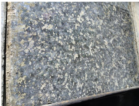
รูปที่ 4.15 แผ่นผนังไม้เทียมจากต้นมันสำปะหลังผสมซีเมนต์ อัตราส่วน 1:0.09 สำหรับการก่อสร้างผนังอาคาร
