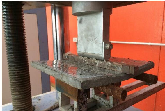
รูปที่ 6 การทดสอบความต้านทานแรงดัดของแผ่นผนังไม้เทียมผสมต้นมันสำปะหลัง
