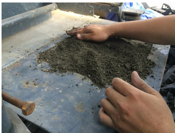
รูปที่ 3.21 การเทส่วนผสมลงในแบบหล่อของเครื่องอัดแผ่นผนังไม้เทียมแบบสันเขย่า
