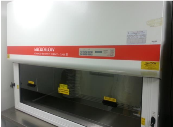
ภาพที่ 13: Micro flow box ภายใน Clean room ที่ใช้ในการประกอบหัววัด GEM
