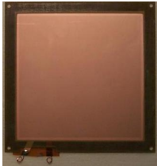
ภาพที่ 9: ภาพแสดงแผ่น GEM พร้อมกรอบที่สามารถสั่งซื้อมาจาก CERN
