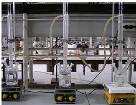
รูปภาพผนวกที่ 1 การทำเมทิลเลชันของน้ำมันด้วยการรีฟลักซ์
