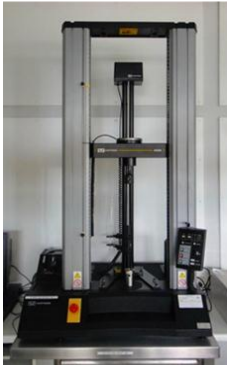
รูปที่ 19 เครื่อง Instron Universal Testing รุ่น Instron 5566
