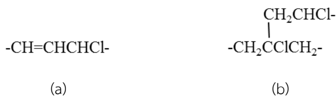
รูปที่ 3 จุดบกพร่องที่เกิดจากโครงสร้างที่มีลักษณะไม่คงที่ในสายโซ่พีวีซี [19]
