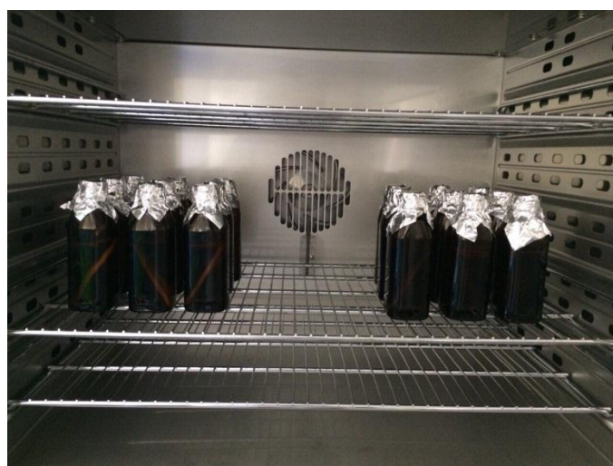
รูปที่ 18 การจำลองสภาวะการใช้งานโดยการใช้ตู้อบ
