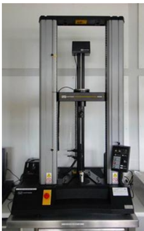
รูปที่ 19 เครื่อง Instron Universal Testing รุ่น Instron 5566
