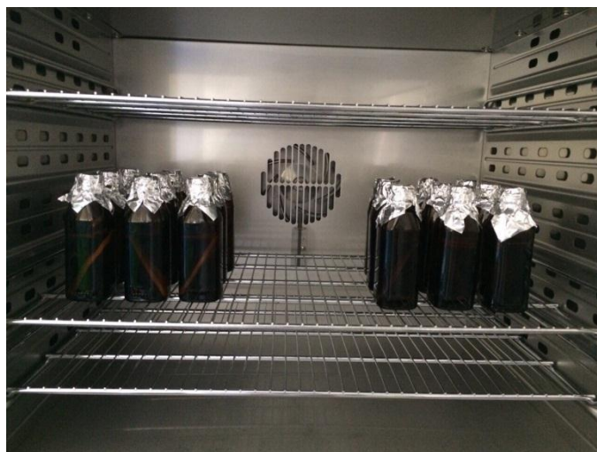
รูปที่ 18 การจำลองสภาวะการใช้งานโดยใช้ตู้อบ
