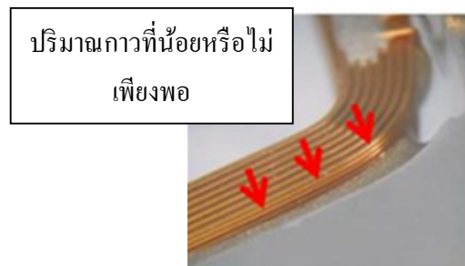
รูปที่ 2.9 ปริมาณกาวที่น้อยหรือไม่เพียงพอ
