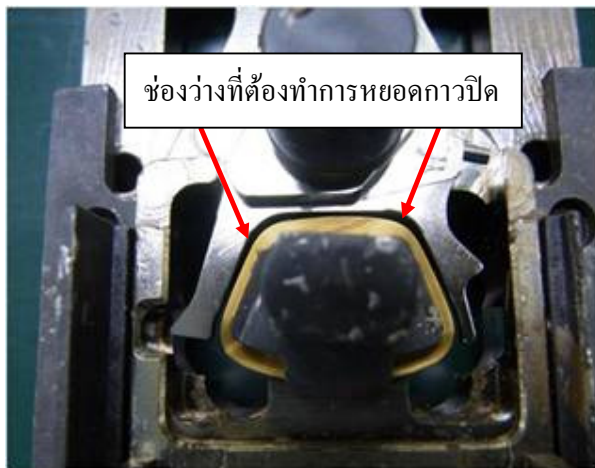
รูปที่ 2.8 ช่องว่างระหว่างผนังอลูมิเนียมขึ้นรูป และขดลวดนำไฟฟ้า
