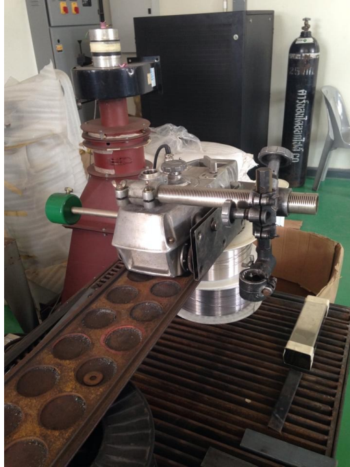
รูปที่ 3.17 รูปร่างของอุปกรณ์จับยึดหัวเชื่อมแบบเคลื่อนที่
