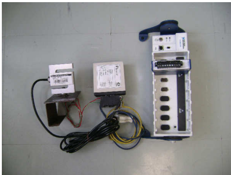
รูปที่ 3.7 อุปกรณ์วัดและบันทึกผลด้วย Load cell และ NI CompactRIO
