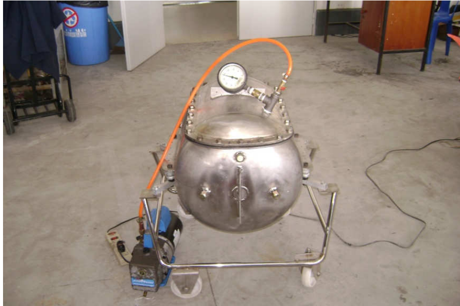
รูปที่ 3.23 การทดสอบรอยรั่วด้วยความดันสุญญากาศ
