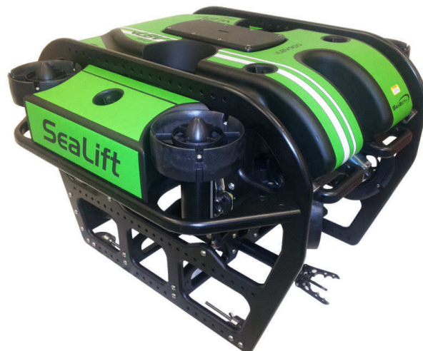
รูปที่ 3.17 ชุดขับเคลื่อนแนวตั้งของยานใต้น้ำขนาดเล็ก SeaLift [38]
