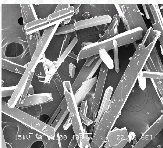
ภาพผนวกที่ ค2 ภาพถ่ายจากเครื่อง SEM ของตัวยา SMX ที่ผ่านตกตะกอนจากกระบวนการ GAS ภายใต้อุณหภูมิ 45 °C ความเข้มข้นของสารละลาย 50%SAT ในตัวทำละลายอะซิโตน
