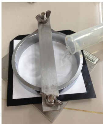
ภาพผนวกที่ ข16 วิเคราะห์ค่าการดูดซึมน้ำ cobb test (Tappi 441)
