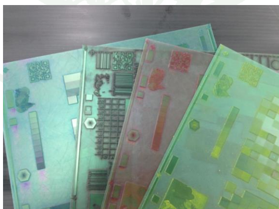
ภาพผนวกที่ ข18 แม่พิมพ์เฟล็กโซกราฟี สี CMYK เป็นยางสังเคราะห์พื้นนูน แม่พิมพ์มีความหนา 1.14 มิลลิเมตร มีรายละเอียด 31.5 lpc
