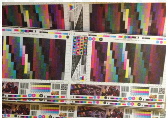
ภาพผนวกที่ ข20 งานพิมพ์ 4 สีบนกระดาษกราฟด์ขาวที่ผ่านเคลือบซิลิกานาโนจากแถบข้าวที่อัตราส่วนผสมต่างร้อยละ 0-5 ของน้ำหนักรезิน
