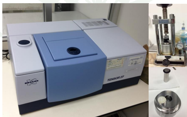
ภาพผนวกที่ ข12 วิเคราะห์องค์ประกอบเพื่อดูหมู่ฟังก์ชันภายในของตัวสารเคลือบที่ผสมซิลิกานาโนจากแคลบข้าวที่อัตราส่วนต่างๆ โดยใช้เครื่อง FT-IR
