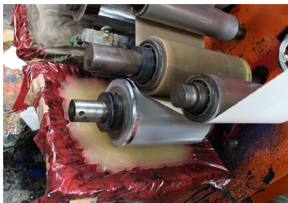
ภาพผนวกที่ ข13 เคลือบผิวกระดาษกราฟด้วยสารเคลือบผสมซิลิกานาโนจากเกลบข้าวที่อัตราส่วนต่างๆ ด้วยการเคลือบระบบลูกกลิ้งกราเวียร์ ขนาด 23.5 lpc
