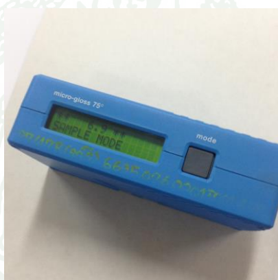
ภาพผนวกที่ ข14 วัดค่าความมันวาวกระดาษกราฟด้วยเครื่องวัดค่าความมันวาว มุม 75 องศา
