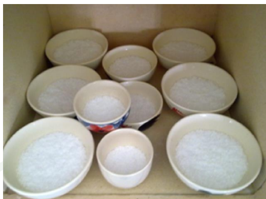
ภาพผนวกที่ ข4 ถั่วแกลบที่ผ่านการเผาที่อุณหภูมิ 650 องศาเซลเซียส 240 นาที
