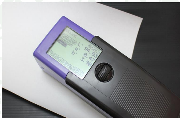
ภาพผนวกที่ ข23 วัดค่าพิกัดสีของกระดาษและงานพิมพ์ด้วยเครื่องสเปกโตรโฟโตมิเตอร์
