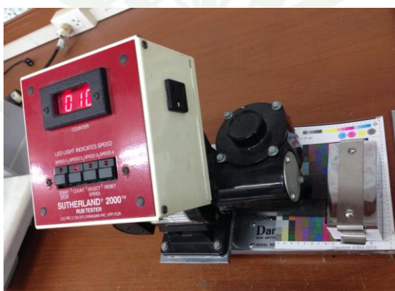
ภาพผนวกที่ ข24 ทดสอบความทนทานต่อการขัดถูของงานพิมพ์ ด้วยเครื่อง Sutherland Rub Tester (ASTM D 5264-98)
