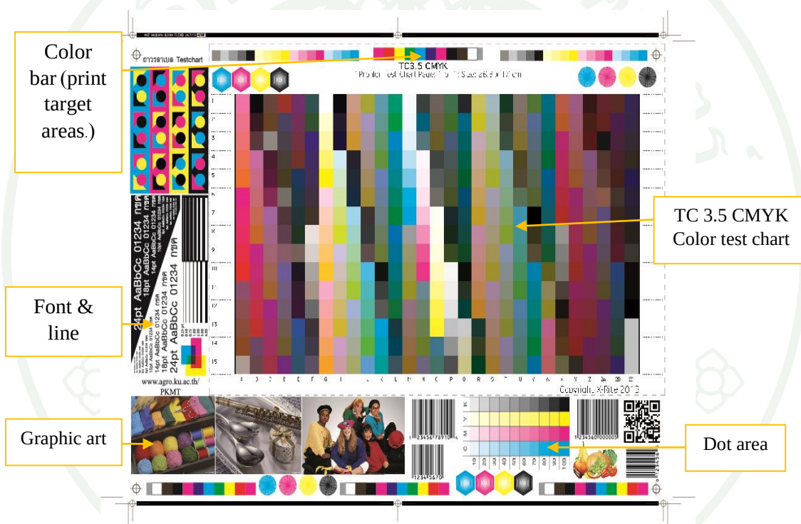
ภาพที่ 32 แบบจำลองงานพิมพ์ (TC3.5) สำหรับวิเคราะห์คุณภาพทางการพิมพ์
