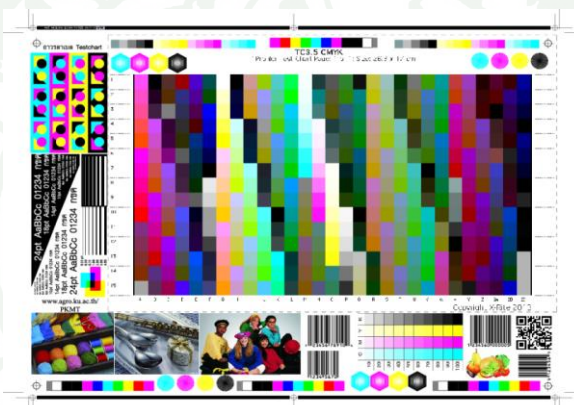
ภาพผนวกที่ ข17 ไฟล์งานทดสอบสี (test chart) สำหรับวิเคราะห์คุณภาพงานพิมพ์
