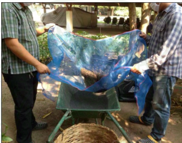
ภาพที่ 2 การแยกสิ่งเจือปนที่ผสมมากับเถ้าแกลบ ด้วยตาข่ายพลาสติก
