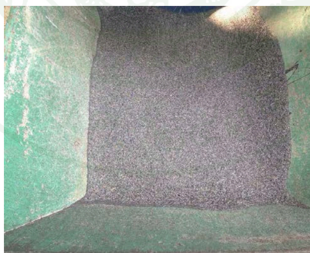
ภาพที่ 3 เถ้าแกลบที่ใช้เป็นส่วนผสมในเนื้อกระเบื้องเซรามิกตัวอย่าง
