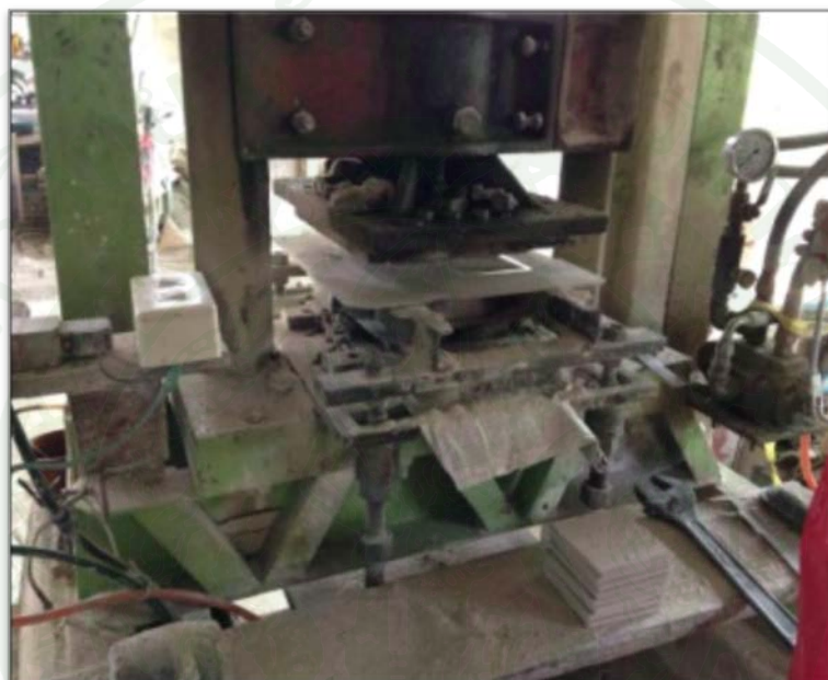
ภาพที่ 5 เครื่องอัดไฮดรอลิกส์ที่ใช้ในการศึกษา
