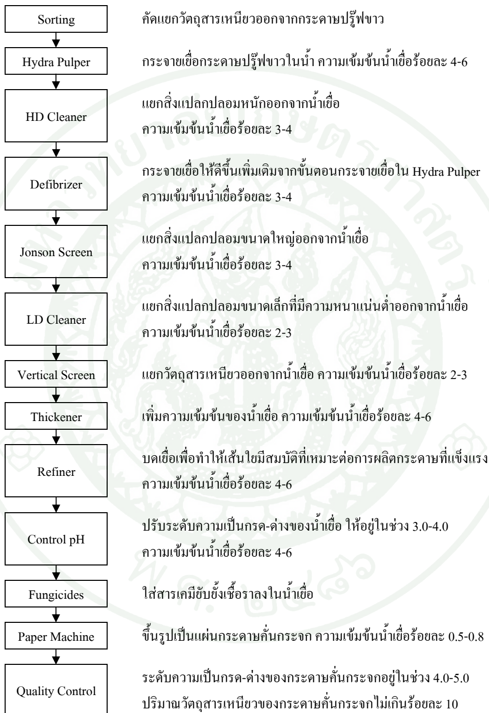
ภาพที่ 2 กระบวนการผลิตกระดาษกึ่งกระดาษกึ่ง
