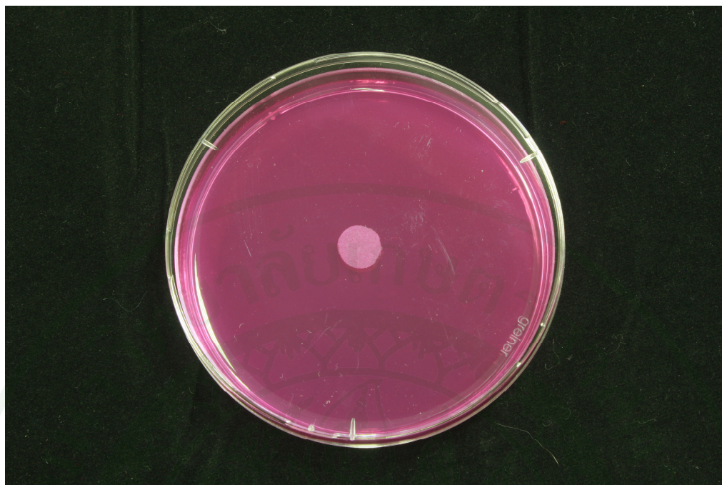
ภาพที่ 7 แผ่นชิ้นตัวอย่างๆ ที่ถูกเจาะตัดและนำไปวางบนอาหาร GAN ในจานอาหารเลี้ยงเชื้อ ขนาดเส้นผ่านศูนย์กลาง 9 เซนติเมตร
