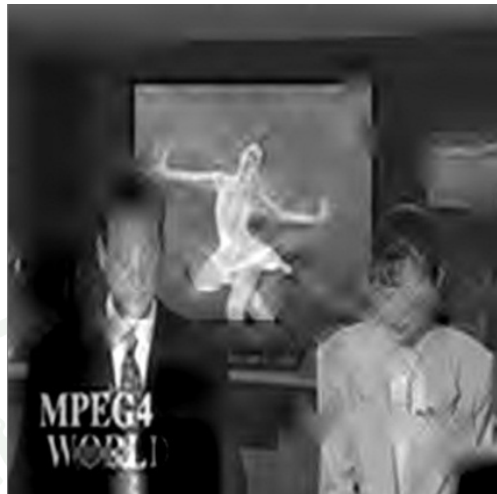
ภาพที่ 43 ภาพ NEWS frame number 140 ที่สร้างกลับมาโดยไม่ใช้การสลับลำดับข้อมูลกับการถอดรหัสวิธี MAP \overline{\gamma}_b = 5 dB m = 2.5 N_s = 10 โดยไม่ผ่านการสลับลำดับข้อมูลร่วมกับ การตรวจจับวิธี MAP โดยใช้ค่าเมตริกซ์ความน่าจะเป็นของการส่งผ่านแบบมismatch (STPM of Mismatched) ได้ค่า PSNR = 18.12326 dB WER = 0.0045
