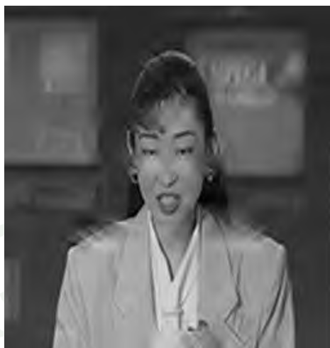
ภาพที่ 129 ภาพ AKIKO frame number 37 ที่สร้างกลับมาโดยใช้การสลับลำดับข้อมูลกับการถอดรหัสวิธี MAP โดยใช้ค่าเมตริกซ์ความน่าจะเป็นของการส่งผ่านแบบมismatch (STPM of Mismatched) ที่ \overline{\gamma}_b = 3.75 dB m = 2 N_s = 6 ใช้การสลับลำดับข้อมูลที่กำหนดค่าได้ขนาด 128 ได้ค่า PSNR 29.5162 dB WER = 9.4515E-4
