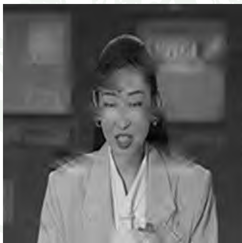
ภาพที่ 130 ภาพ AKIKO frame number 37 ที่สร้างกลับมาโดยใช้การสลับลำดับข้อมูลกับการถอดรหัสวิธี MAP โดยใช้ค่าเมตริกซ์ความน่าจะเป็นของการส่งผ่านแบบ mismatch (STPM of Mismatched) ที่ \overline{\gamma}_b = 3.75 dB m = 2 N_s = 6 ใช้การสลับลำดับข้อมูลที่กำหนดค่าได้ขนาด 143 ได้ค่า PSNR = 30.4186 dB WER = 4.826E-4
