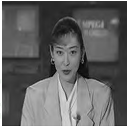
ภาพที่ 143 ภาพ AKIKO frame number 150 ที่สร้างกลับมาโดยใช้การสลับลำดับข้อมูลกับการถอดรหัสวิธี MAP โดยใช้ค่าเมทริกซ์ความน่าจะเป็นของการส่งผ่านแบบแมช (STPM of Matched) ที่ \overline{\gamma}_b = 3.75 dB m = 2 N_r = 6 ใช้การสลับลำดับข้อมูลที่กำหนดค่าได้ขนาด 32 ได้ค่า PSNR = 29.3672 dB WER = 0.0011293
