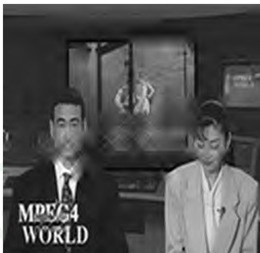
ภาพที่ 95 ภาพ NEWS frame number 90 ที่สร้างกลับมาโดยใช้การสลับลำดับข้อมูลกับการถอดรหัสวิธี MAP โดยใช้ค่าเมทริกซ์ความน่าจะเป็นของการส่งผ่านแบบแมช (STPM of Matched) ที่ \overline{\gamma}_b = 3.75 dB m = 2 N_s = 6 ใช้การสลับลำดับข้อมูลที่กำหนดค่า ได้ขนาด 128 ได้ค่า PSNR = 25.93074 dB WER = 9.31245E-4
