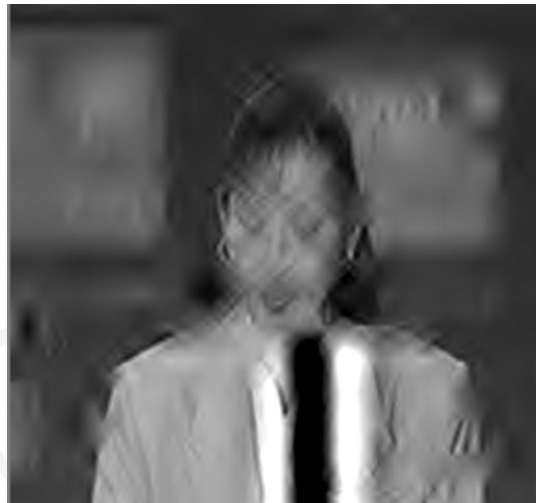
ภาพที่ 49 ภาพ AKIKO frame number 80 ที่สร้างกลับมาโดยไม่ใช้การสลับลำดับข้อมูลกับการถอดรหัสวิธี MAP \overline{\gamma}_b = 5 dB m = 2 N_s = 10 โดยไม่ผ่านการสลับลำดับข้อมูลร่วมกับการตรวจจับวิธี MAP โดยใช้ค่าเมทริกซ์ความน่าจะเป็นของการส่งผ่านแบบแมช (STPM of Matched) ได้ค่า PSNR = 18.5679 dB WER = 0.0047
