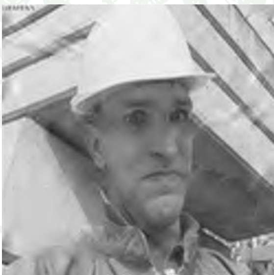
ภาพที่ 57 ภาพ Foreman frame number 100 ที่สร้างกลับมาโดยใช้การสลับลำดับข้อมูลกับการถอดรหัสวิธี MAP โดยใช้ค่าเมทริกซ์ความน่าจะเป็นของการส่งผ่านแบบมismatch (STPM of Mismatched) ที่ \overline{\gamma}_b = 3.75 dB m = 2 N_s = 6 ใช้การสลับลำดับข้อมูลที่กำหนดค่าได้ขนาด 64 ได้ค่า PSNR = 26.83698 dB WER = 9.721E-4
