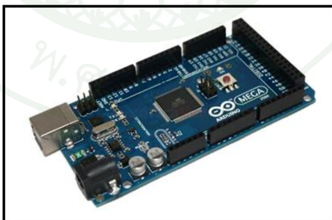
ภาพที่ 12 อุปกรณ์ไมโครคอนโทรลเลอร์ (Arduino Mega 2560 R3)
