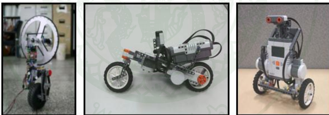
ภาพที่ 2 (ซ้าย) หุ่นยนต์ล้อเดียว (Unicycle Robot) (กลาง) Lego NXTbike-GS (ขวา) NXTway-GS (Self-Balanceing Two Wheeled Robot)
