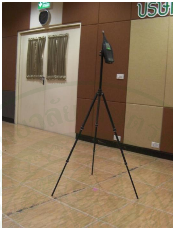
ภาพผนวกที่ ข1 เครื่องมือตรวจวัดระดับความดังเสียงและขาตั้ง Tripod
