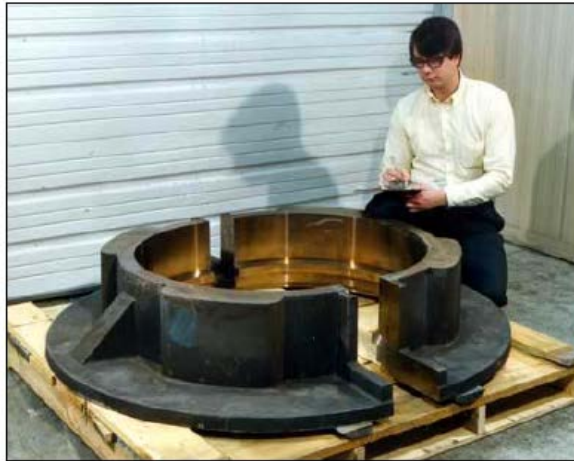
รูปที่ 2.4 ตัวอย่างชิ้นงานที่ทำด้วยวัสดุโลหะผสมเกรด C95800
