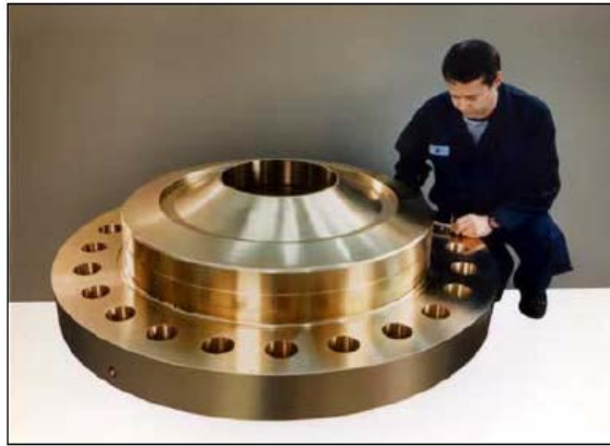
รูปที่ 2.2 ตัวอย่างชิ้นงานที่ทำด้วยวัสดุโลหะผสมเกรด C95800
